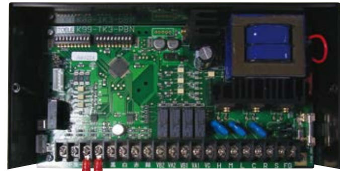
寸法:W209×H107×L50mm ※配管温度センサー付き ※操作部の蓋を開けた状態です
