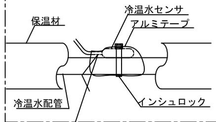
センサの根本部分を曲げない様に設置して下さい。
