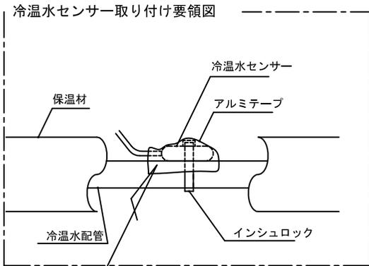
センサー部分と配線部分はストレートになるようにして下さい。
